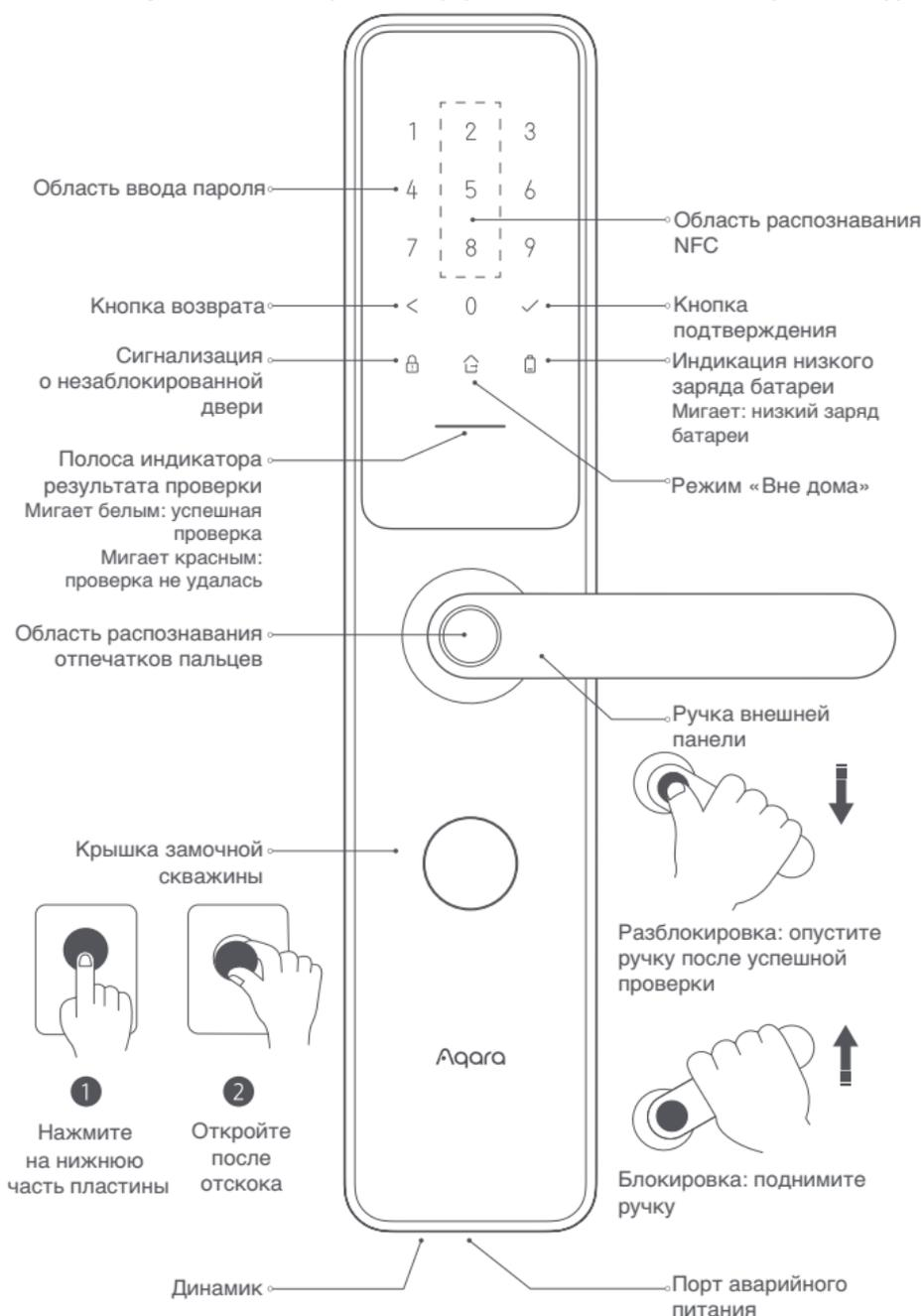
Подсказка: если устройство не работает из-за полного разряда батарей, для разблокировки замка можно подключить переносной аккумулятор (powerbank) к порту аварийного питания.
